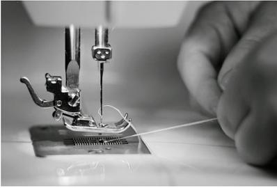
Une machine à coudre est nécessaire pour assembler les différentes parties d'un vêtement.
